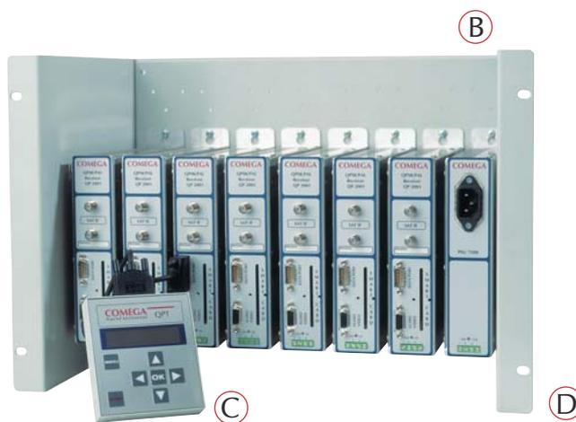
QPT speciellt framtagen för QP 2001. Programmeringsenheten är inbyggd i ett mycket robust metallkabinett. Med QPT gör man enkelt alla inställningar eller kontrollerar gjorda inställningar. Programmering och övervakning kan även göras via Comand line interface (CLI), vilket är hanterbart med hjälp av t.ex. Hyperterminal, vilket är ett program, som Windows tillhandahåller. Genom att ansluta flera QP 2001 till en serverbox möjliggör det att fjärrstyra samt övervaka via Internet eller telefon nätet.
